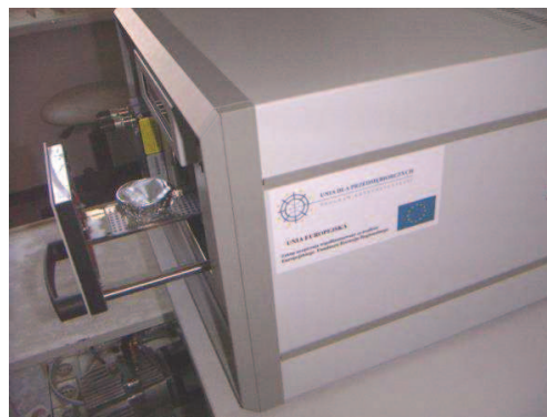
Fot. 1. Niskotemperaturowy spopielacz plazmowy typu K1050X (zakup urządzenia współfinansowany ze środków Europejskiego Funduszu Rozwoju Regionalnego i Głównego Instytutu Górnictwa)
